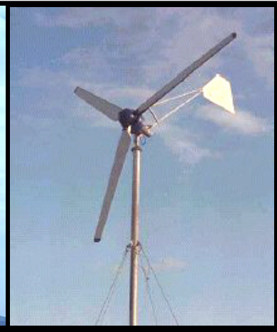
Aerogenerador de 5 kW
